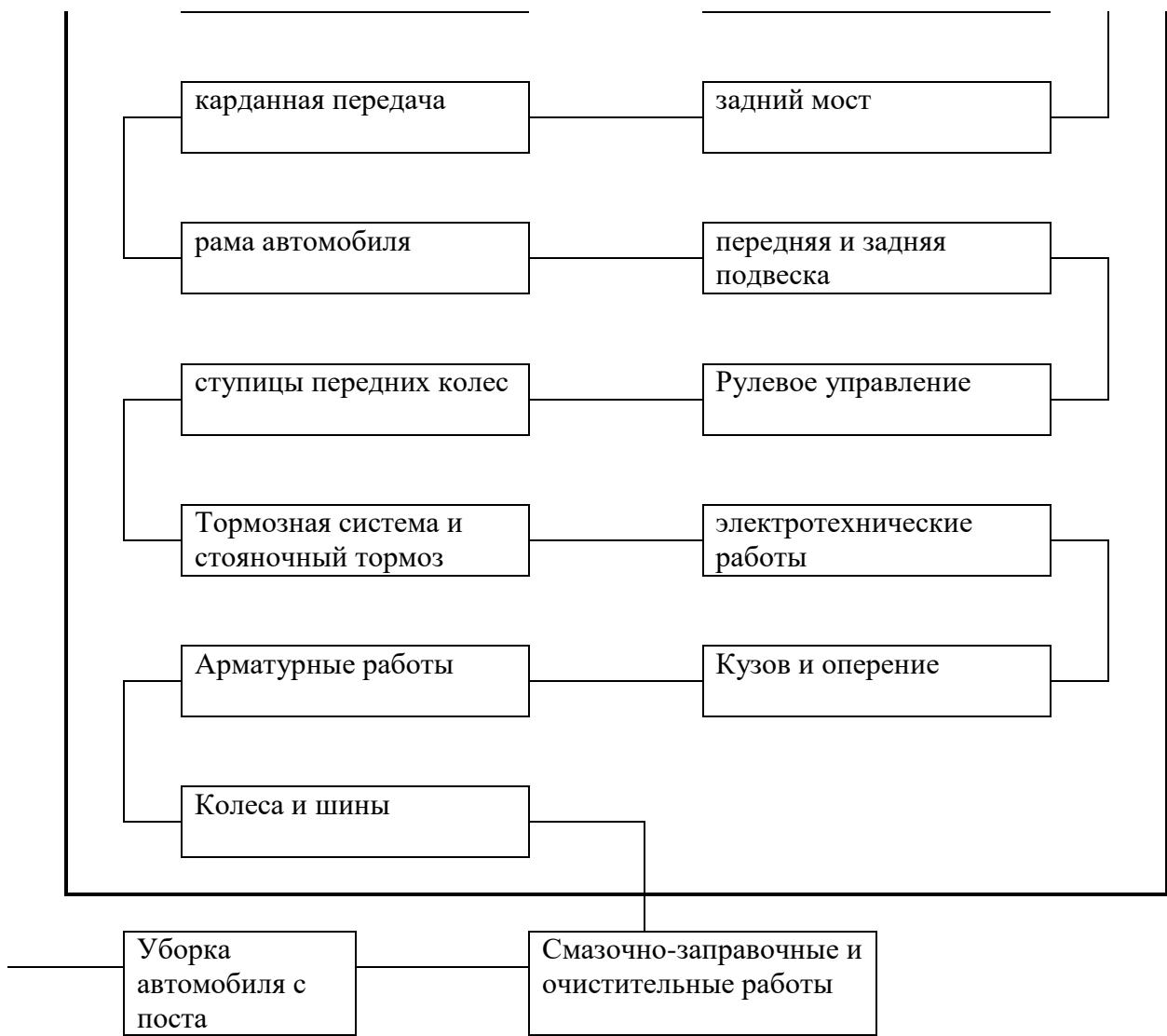
Рисунок 1.1 - Схема технологического процесса на посту ТО-1
