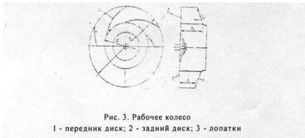
Передние диски более сложной формы практически не применяются. Меридиональное сечение рабочего колеса характеризуется двумя параметрами:  $B_1$  - шириной на входе;  $B_2$  - шириной при входе на лопатки. Лопатки рабочего колеса обычно имеют цилиндрическую форму; их устана-ливают перпендикулярно плоскости заднего диска. Выходные кромки лопаток могут быть загнутыми вперед ( $D > 90^\circ$ ) (рисунок 4), радиальными ( $D \wedge 90^\circ$ ) и загнутыми назад ( $D < 90^\circ$ ).
